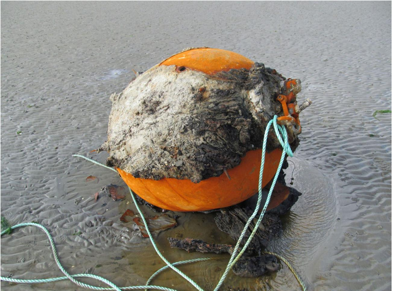
**Abbildung 1.4:** Britische Ankertaumine vom Typ MK17 aus der Zeit des zweiten Weltkriegs, gefunden nordwestlich vor Borkum im Zuge von Sondierungsarbeiten für eine Kabeltrasse. Trotz einer Liegezeit von ca. 70 Jahren in der Nordsee, befindet sich die Ankertaumine in einem relativ guten Zustand, die zündauslösenden Stoßkappen sind teilweise noch vorhanden. Die Anhaftungen und der Bewuchs auf der Mine sind zum Teil durch Wellen- und Seeschlag abgefallen (Foto: KBD Nds, 2015).
