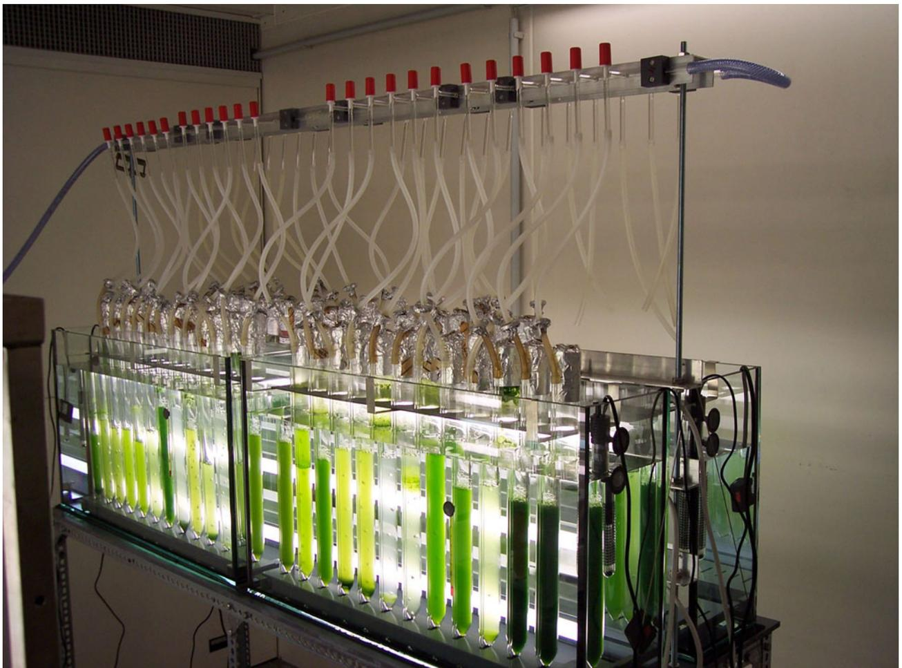
**Abbildung 5.5:** Blick auf den Versuchsaufbau für die Kultivierung und Untersuchung von unterschiedlichen Mikroalgen-Stämmen in Knieseröhren mit Begasungssystem. Das enthaltene Meerwasser wurde mit unterschiedlichen Konzentrationen von TNT versetzt (Foto: Dr. O. Mudimu, 2015).
